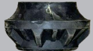
CAUCHO DESGASTADO NORMAL DEL AMORTIGUADOR SUPERIOR PRIMERA CALIDAD
