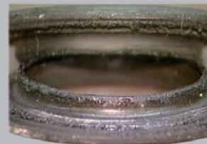
COJINETE DE AMORTIGUADOR DESGASTADO CALIDAD INFERIOR
